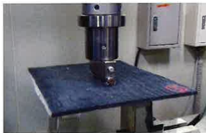
補修箇所に負荷をかけてもこの通り
